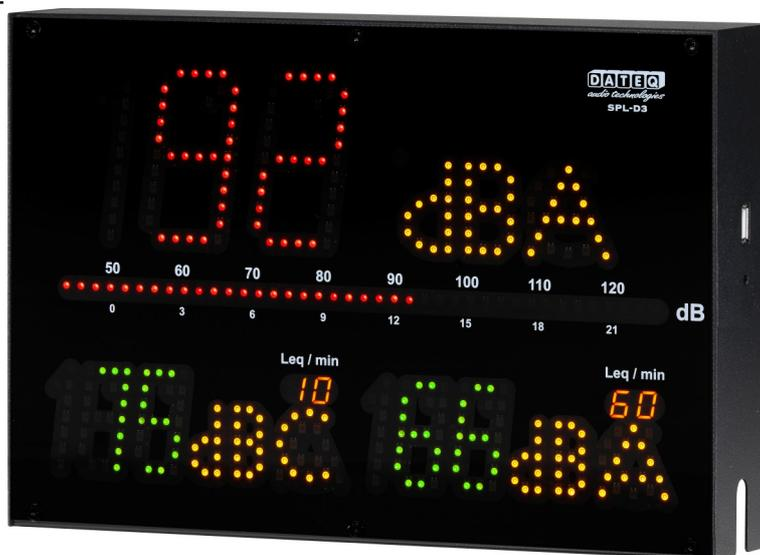
SPL-D3mk2 è dotato di un display di livello audio avanzato che memorizza i campioni di livello sonoro per almeno 60 giorni. I campioni di livello sonoro possono essere visualizzati utilizzando il software di configurazione o memorizzati esternamente attraverso un drive USB FAT32. È possibile memorizzare anche altri dati importanti come l'accensione, le sanzioni o eventuali manomissioni.
